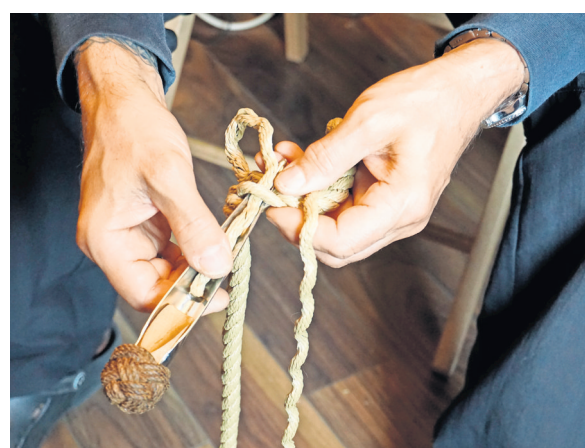
Knoten-Ole beim Spleißen – Tawe werden dabei fest miteinander verbunden und lose Enden geschickt im Tau versteckt.
